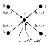
Gambar 2. Filter digital total variation pada piksel  $\alpha$  dan  $\beta$ ,  $\gamma$ ,  $\delta$ ,  $\tau$  adalah piksel tetangga pada  $N_D(\alpha)$ . Tiap panah menyatakan nilai u pada tiap piksel dikalikan dengan koefisien filter dan ditambahkan pada  $\alpha$ .
